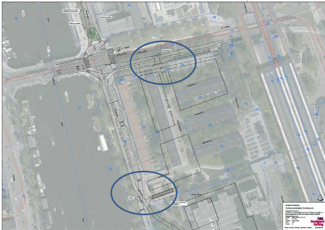
Figuur 11: optimalisatievariant 3. nieuwe ontsluiting gemotoriseerd verkeer (rechts in – rechts uit) Weesperzijde – Van der Kunbuurt op de Treublaan.
