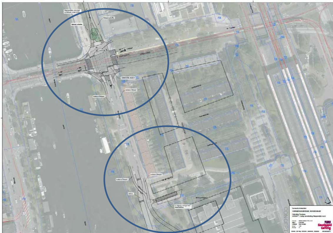
Figuur 9: optimalisatievariant 1. Wijziging op kruising Treublaan – Weesperzijde en ingang fietsgarage.
