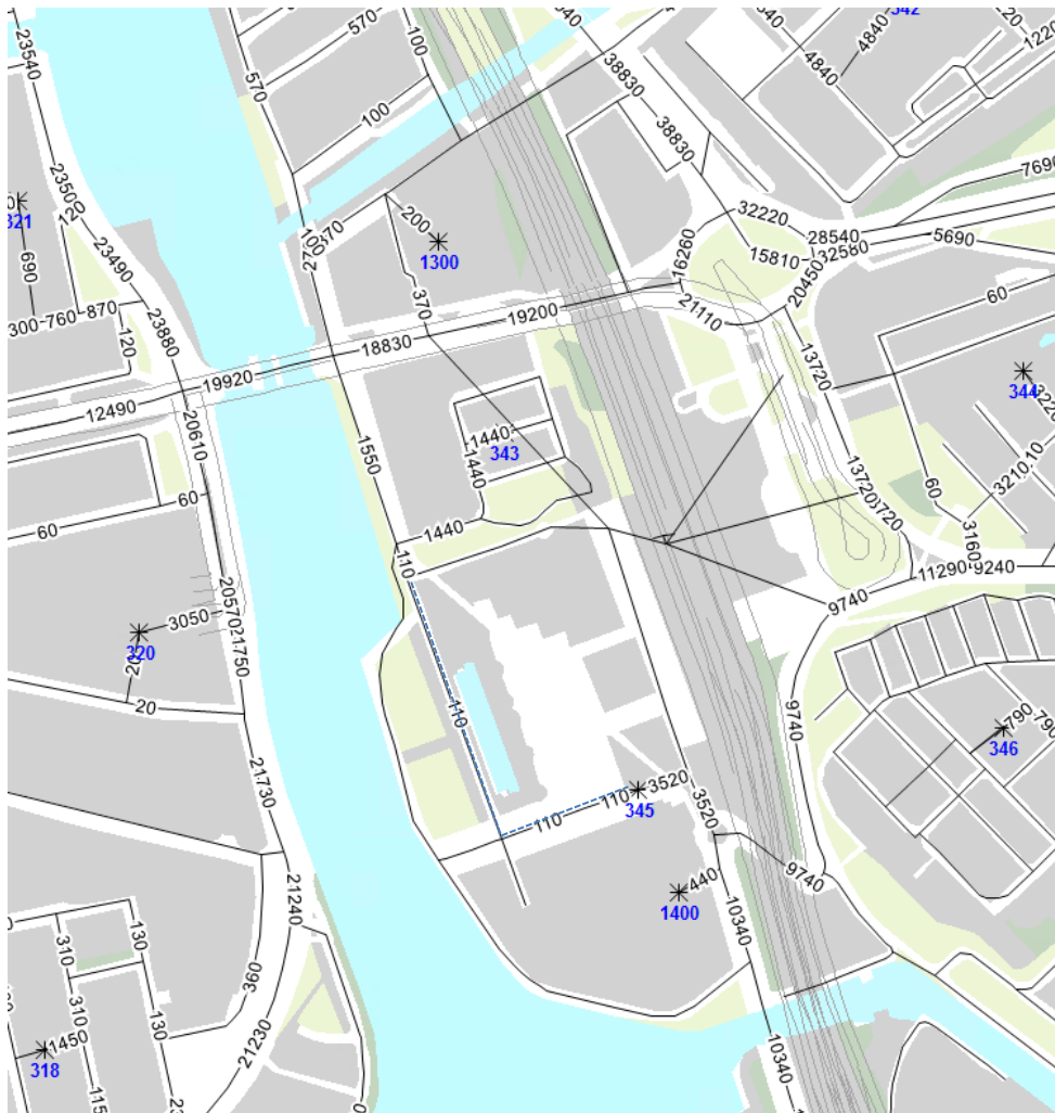
Figuur 5: intensiteiten (beide rijrichtingen samen) gemotoriseerd verkeer op etmaalniveau huidige situatie Het verkeer vanuit de gehele zone takt via voedingslinks aan op het netwerk. Het verkeer vanuit het gebied zone 345 rijdt circa 110 mvt richting Treublaan en 3520 mvt richting Spaklerweg – Overzichtsweg
